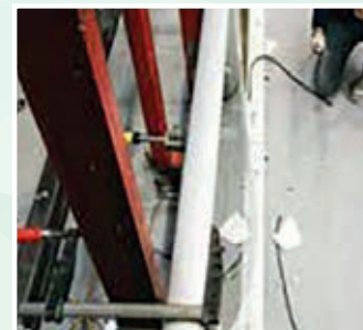
PUNKTBELASTNING: Her belastes glasset med over 800 kilos trykk, før glasset sviktet på 840 kilo. FORNØYDE: Terje Svendsen fra SG RAILING er glad for de gode resultatene etter de fysiske testene utført ved SINTEF Byggforsk. Dette var imponerende sa forskningsingeniør Per Chr. Moe etter testen. SG RAILING er testet ved SINTEF Byggforsk etter revidert forslag til NS 3510.
