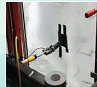
PUNKTBELASTNING: Her belastes glasset med over 800 kilos trykk, før glasset sviktet på 840 kilo. FORNØYDE: Terje Svendsen fra SG RAILING er glad for de gode resultatene etter de fysiske testene utført ved SINTEF Byggforsk. Dette var imponerende sa forskningsingeniør Per Chr. Moe etter testen. SG RAILING er testet ved SINTEF Byggforsk etter revidert forslag til NS 3510.
